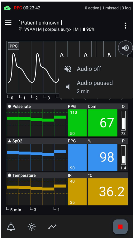
Commandes du signal acoustique de l’onde de pouls : Affiche les options permettant d’activer, de désactiver ou de mettre en pause le signal sonore pour les notifications pendant la surveillance.
